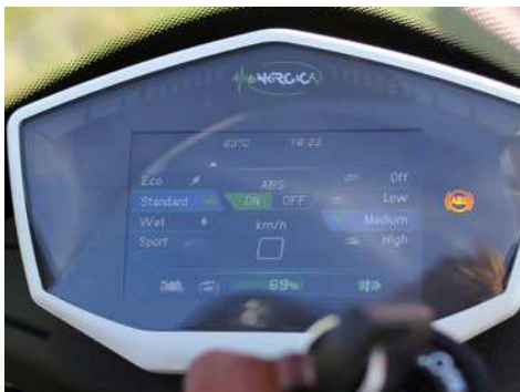
Übersichtlicher Farbbildschirm, hier im Menü, mit dem man die Modi von Motor und Rekuperation auswählt.
