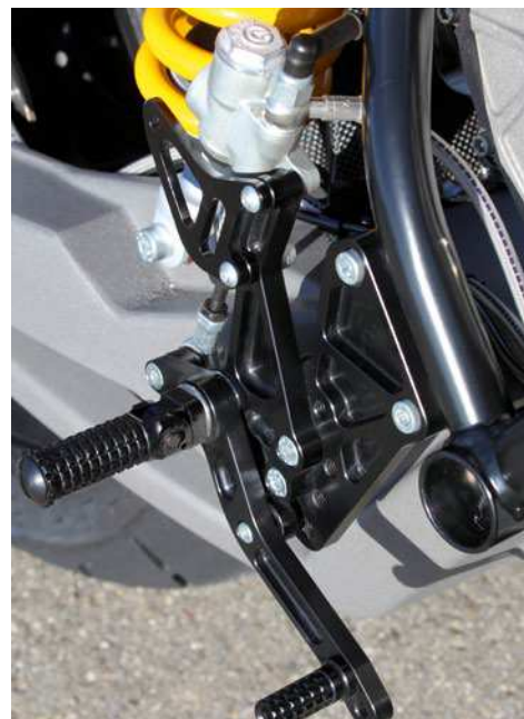
Hochwertige, einstellbare Fussrastenanlage, Hinterbremse konventionell betätigt - denkbar wäre auch ein Handhebel links.
