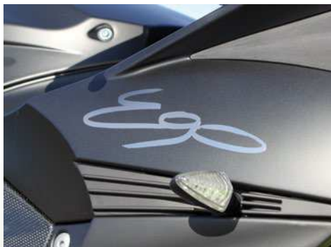
Verschaltung aus Windform, einem per Laserstrahl gesinterten Kunststoff.
